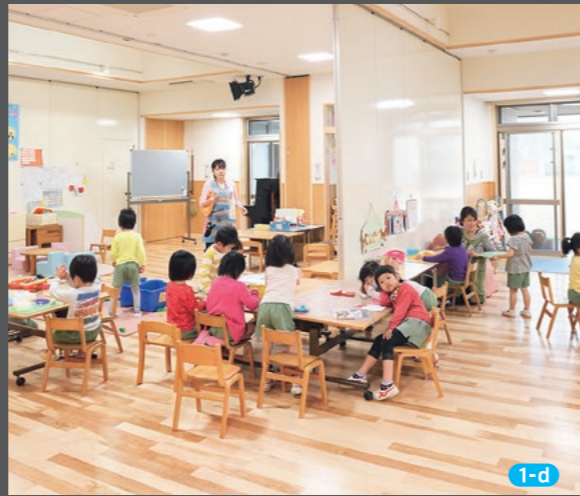
〈3・4・5才児保育室〉 全面でマグネット掲示ができるスライディングウォールの間仕切りは、壁に収納することで3部屋がつながり、1つの大きなホールとして利用できる
