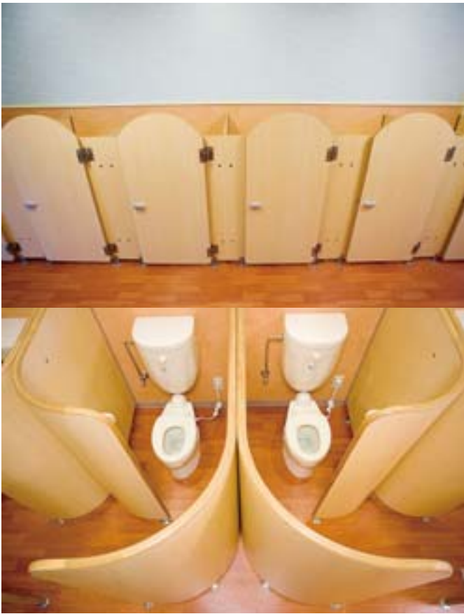
(上) 年長児用トイレの扉は、指はさみ防止を考慮して、ドアとブースの間に約20mmの隙間が生まれるように設計しています。(下) アールの曲線が特徴的な年少児用のノンポルトブース。真ん中に先生が立つことで、同時に2人の補助ができます。
