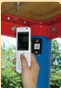
携帯電話で、設置日・標準使用期間・消耗部材などの維持管理情報が読み取れる。
