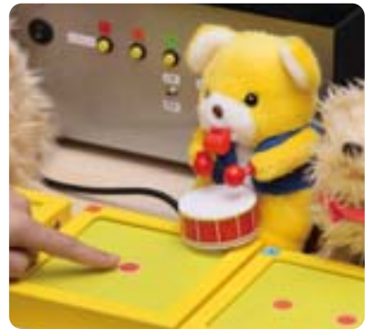
何歳以上なら長押しができるか— チャイルドロックの実験に使った装置。
